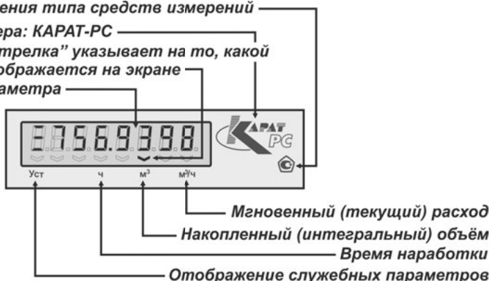
Рисунок 1.9 – Пример внешнего вида экрана ЖКИ
